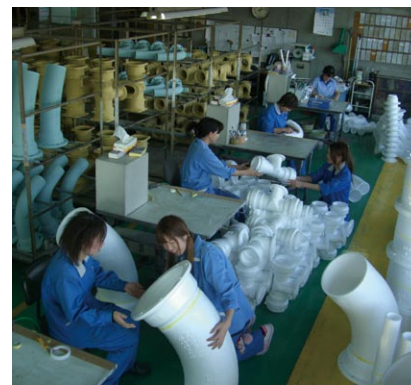
発泡模型の組立・仕上げの様子
